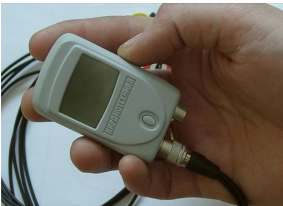
Рисунок 2. Современные холтеровские мониторы весьма миниатюрны и могут регистрировать 12 отведений ЭКГ в течение недели.
